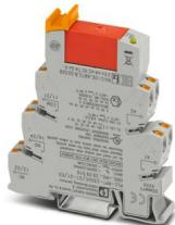
PLC-INTERFACE, composta da morsetto base montabile su guida da 14 mm con connessione Push-in e relè a innesto con contatto di potenza, 2 contatti di scambio, tensione di ingresso 230 V AC/220 V DC. Omologata secondo ATEX/IECEx (zona 2) e zona Ex Class I, Div. 2.
