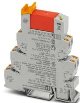
PLC-INTERFACE, composta da morsetto base montabile su guida da 14 mm con connessione Push-in e relè a innesto con contatto di potenza, 2 contatti di scambio, tensione di ingresso 24 V DC. Omologata secondo ATEX/IECEx (zona 2) e zona Ex Class I, Div. 2.
