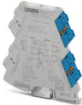
Ex i-L'isolatore galvanico d'ingresso e di alimentazione trasmette segnali alimentati o attivi 0 mA / 4 mA ... 20 mA dalla zona Ex a un carico nel campo sicuro. trasparenza HART, tensione a vuoto: 15 V DC, Configurazione standard, Riconoscimento guasto linea, Safety Integrity Level (SIL, IEC 61508): 3, Connessione a vite
