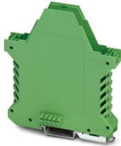
Custodie per guide DIN, Base custodia con piedino di fissaggio in metallo, con contatto FE, di tipo alto, con feritoie di ventilazione, larghezza: 17,6 mm, altezza: 99 mm, profondità: 107,3 mm, collegamento trasversale: connettore bus integrato, n. poli connettore trasversale: 5, Connettore bus: 5 contatti paralleli
