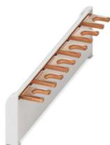
Ponticello di cablaggio per i moduli con passo di 17,5 mm, monofase, a 6 poli, sezione trasversale di 35 mm<sup>2</sup> e calotte terminali montate
