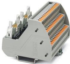
Modulo di trasmissione VARIOFACE COMPACT LINE per sistemi Siemens S7-1500 con marcatura specifica S7-1500, per canali 1 – 16, con connessione Push-in, larghezza modulo: 82,5 mm
