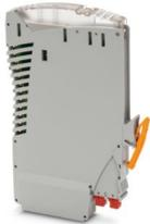
Isolatore galvanico d'ingresso e di alimentazione Ex ic, HART per elementi di base VIP I/O-Marshalling: trasmette segnali di 0/4 ... 20 mA dalla zona Ex (zona 2, CID2) ai carichi (attivi o passivi) del campo sicuro. Separazione galvanica a 3 vie
