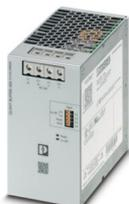
Modulo buffer QUINT con accumulatore di energia che non richiede manutenzione grazie al condensatore per il montaggio su guida di supporto, ingresso: 24 V DC, uscita: 24 V DC / 40 A, incl. adattatore per guide di supporto universali montato UTA 107.
