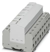
Scaricatore di corrente da fulmine a innesto senza corrente di dispersione per tensioni nominali elevate, conforme a Tipo 1/ Classe I, per reti di alimentazione trifase con N e PE separati (L1, L2, L3, PE, N).
