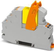
Modulo relè premontato con connessione Push-in, costituito da: base per relè, relè di sicurezza con contatti a carica positiva secondo DIN EN 61810-3, modulo a inserto di visualizzazione/soppressione dei disturbi e leva di fissaggio, esecuzione contatti: 2 contatti di scambio, tensione di ingresso: 24 V DC
