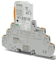
Protezione contro la sovratensione, composta da spina estraibile ed elemento base, con indicatore di stato integrato per due fili di segnale con potenziale di riferimento comune, ad es. digitale IN/OUT. Utilizzabile nei circuiti di sicurezza fino a SIL 3.
