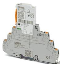
Protezione contro la sovratensione, composta da spina estraibile ed elemento base, con indicatore di stato integrato per un circuito del segnale a 2 fili libero da potenziale di terra. Messa a terra indiretta mediante scaricatore a gas. Utilizzabile nei circuiti di sicurezza fino a SIL 3.
