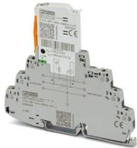
Protezione contro la sovratensione, composta da spina estraibile ed elemento base, con indicatore di stato integrato per un circuito del segnale a 2 fili libero da potenziale di terra. Utilizzabile nei circuiti di sicurezza fino a SIL 3.
