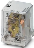
Relè a prestazioni elevate a innesto con contatti di potenza, pensato per la disattivazione di carichi DC elevati, 1 contatto in chiusura, magneti di estinzione, tensione bobina: 24 V DC
