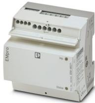
Dispositivo di misurazione dell'energia multifunzionale senza display con connessione Rogowski diretta e interfaccia Modbus/TCP integrata per la misurazione di parametri elettrici in impianti a bassa tensione fino a 690 V. ([phoenixcontact.com/empro-help](https://www.phoenixcontact.com/empro-help))
