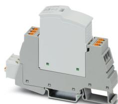
Protezione contro le sovratensioni Tipo 2/3, composta da spina di protezione ed elemento base con connessione Push-in. Per reti di alimentazione monofase con indicatore di stato integrato e segnalazione remota. Tensione nominale: 230 V AC/DC
