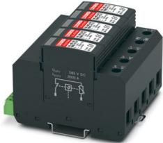
Dispositivo di protezione contro le sovratensioni per impianti a tensione continua isolati (1000 V DC), montaggio su guida, elemento base a 5 poli con contatto FM, modulo connettori di protezione a innesto a 5 poli con monitoraggio della temperatura e segnalazione di stato per ogni connettore, per l'uso con dispositivi di protezione con tre stringhe / inseguitori del punto di massima potenza (Maximum Power Point Tracker, MPPT) in parallelo.
