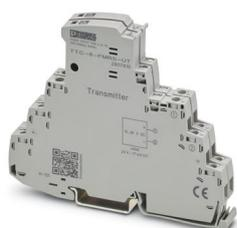
Set di moduli per il monitoraggio ottico e la segnalazione a distanza libera da potenziale degli scaricatori di sovratensione adiacenti della famiglia di prodotti TERMITRAB complete o CLIXTRAB. Adatto per guide DIN con messa a terra diretta.
