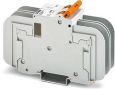
Interruttore TM (termomagnetico), 2-poli, utilizzo: Branch Circuit Protection (UL 489), per la protezione dal sovraccarico con capacità di interruzione di 10 kA, curva caratteristica di intervento: C, tipo di montaggio: NS 35 ..., corrente nominale: 4 A
