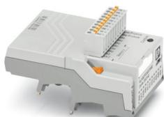
Modulo PLC logic stand alone, generazione 2, con 16 I/O, per la connessione a innesto su otto morsetti PLC-INTERFACE digitali o analogici, non ampliabile, orologio in tempo reale, connettore femmina Micro-USB, alloggiamento per modulo memoria e adattatore Bluetooth, connessione Push-in
