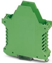
Custodie per guide DIN, Base custodia con piedino di fissaggio in metallo, design alto, con feritoie di ventilazione, larghezza: 22,6 mm, altezza: 99 mm, profondità: 107,3 mm, colore: verde (simili RAL 6021), collegamento trasversale: senza connettore bus, n. poli connettore trasversale: non rilevante
