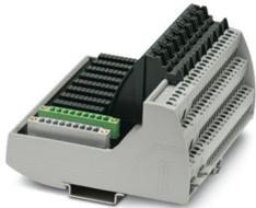
Elemento base VIP I/O-Marshalling a 8 canali per impiego universale. Tutti i collegamenti come tecnologia di connessione a vite. Compatibile con il connettore COMBICON della serie Honeywell C300- e RUSIO. Siglatura per i canali da 25 a 32.
