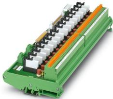
Modulo relè a 16 canali per moduli d'ingresso Honeywell C300. Il modulo viene gestito sul lato controllore mediante D-SUB da 37 poli oppure FLK da 50 poli. Sul lato campo è disponibile una connessione a vite con sezionatore a coltello. Larghezza modulo: 343 mm
