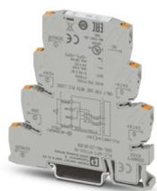
Convertitore di temperatura Pt 100/Pt 1000 per moduli logici PLC logic (solo generazione 2), a 1 canale, tipo di segnale (Pt 100, Pt 1000) configurabile attraverso DIP switch, connessione Push-in
