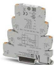
Modulo d'ingresso analogico per moduli logici PLC logic (solo generazione 2), a 1 canale, tipo di segnale (4 mA ... 20 mA, 0 mA ... 20 mA, 0 V ... 10 V, 2 V ... 10 V) configurabile tramite DIP switch, connessione Push-in
