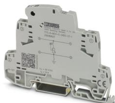
Protezione intermedia contro le sovratensioni con indicatore di stato integrato per un filo del segnale con potenziale di riferimento collegato a terra. Utilizzabile in circuiti di sicurezza fino a SIL 3.
