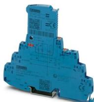
Protezione contro la sovratensione, composta da spina estraibile ed elemento base, con indicatore di stato integrato e coltello sezionatore per un circuito del segnale Ex-i a 2 fili con potenziale di riferimento comune, ad es. digitale IN/OUT. Utilizzabile in circuiti di sicurezza fino a SIL 3.
