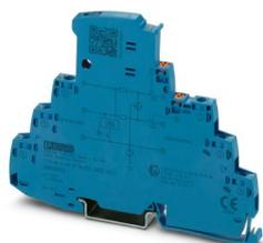
Protezione contro le sovratensioni con indicatore di stato integrato e sezionatore a coltello per un circuito del segnale Ex i a 3 fili con potenziale di riferimento comune. Per applicazioni HF. Messa a terra indiretta mediante scaricatore a gas, compatibile con HART. Adatto per l'utilizzo nel sistema di bus di campo (ad es. Profibus PA) secondo il concetto FISCO. Utilizzabile in circuiti di sicurezza fino a SIL 3.
