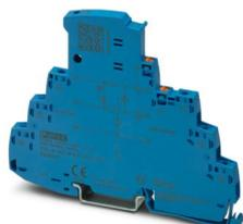
Protezione contro le sovratensioni con indicatore di stato integrato e coltello sezionatore per un circuito del segnale Ex i a potenziale zero a 2 fili, ad es. loop di corrente 0(4) ... 20 mA, compatibile con HART. Utilizzabile in circuiti di sicurezza fino a SIL 3.
