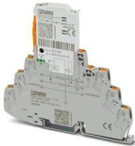
Protezione contro la sovratensione, composta da spina estraibile ed elemento base, con indicatore di stato integrato e sezionatore a coltello per tre fili del segnale con potenziale di riferimento comune. Per applicazioni HF e interfacce di telecomunicazione senza tensione di alimentazione. Messa a terra indiretta tramite scaricatore a gas, omologazione EX e per la zona 2. Utilizzabile in circuiti di sicurezza fino a SIL 3.
