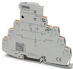
Protezione contro la sovratensione con indicatore di stato integrato e sezionatore a coltello per un circuito del segnale a 2 fili libero da potenziale di terra, ad es. loop di corrente 0(4)...20 mA. Messa a terra indiretta mediante scaricatore a gas, compatibile con HART. Utilizzabile nei circuiti di sicurezza fino a SIL 3.
