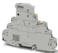
Protezione contro la sovratensione con indicatore di stato integrato e sezionatore a coltello per un circuito del segnale a potenziale zero a 2 fili, ad es. loop di corrente 0(4)...20 mA, omologazione EX e per la zona 2, compatibile con HART. Utilizzabile in circuiti di sicurezza fino a SIL 3.
