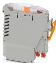
Modulo fusibile per elementi base VIP I/O-Marshalling con fusibili 1 A sostituibili nel percorso di alimentazione del dispositivo da campo e nel percorso del segnale. I punti di prova integrati e un coltello sezionatore consentono di misurare il segnale ininterrottamente.
