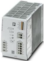
TRIO UPS - UPS con alimentatore integrato, USB (Modbus/RTU), Montaggio su guida DIN, Connessione Push-in, ingresso: 3 fase, uscita: 24 V DC / 20 A
