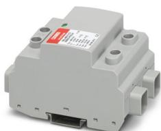
Scaricatore di corrente atmosferica / di sovratensione per sistemi fotovoltaici a tensione continua a 2 poli isolati e collegati a terra 600 V DC, per montaggio su guida DIN, elementi di protezione monitorati termicamente, segnalazione di stato sul modulo.
