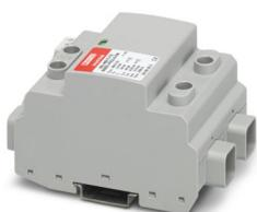
Scaricatore di corrente atmosferica / di sovratensione per sistemi fotovoltaici a tensione continua a 2 poli isolati e collegati a terra 600 V DC, per montaggio su guida DIN, con contatto di segnalazione remota, elementi di protezione monitorati termicamente, segnalazione di stato sul modulo.
