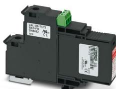
Scaricatore di corrente atmosferica/di sovratensioni ad innesto universale formato da varistore per reti di alimentazione monofase con N e PE comune (sistema a 2 conduttori: L1, PEN), con contatto FM.
