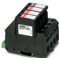
Scaricatore di corrente atmosferica/di sovratensioni ad innesto universale formato da varistore per reti di alimentazione trifase con N e PE separato (sistema a 5 conduttori: L1, L2, L3, N, PE), per classi di protezione contro i fulmini III e IV, con contatto FM.
