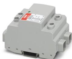
Scaricatore di corrente atmosferica / di sovratensione per sistemi fotovoltaici a tensione continua a 2 poli isolati e collegati a terra 1000 V DC, per montaggio su guida DIN, elementi di protezione monitorati termicamente, segnalazione di stato sul modulo.
