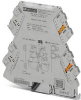
Duplicatore di tensione di alimentazione a 4 vie con tecnica di connessione a innesto. HART trasparente, segnale di ingresso 0(4) mA ... 20 mA, segnale di uscita 0(4) mA ... 20 mA. Il dispositivo può essere utilizzato sia come duplicatore di segnale che come duplicatore di alimentazione. Connessione a vite.
