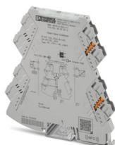
Isolatore galvanico di uscita per separare e trasmettere segnali da 0 mA / 4 mA ... 20 mA dal controllore a un carico a sicurezza intrinseca nella zona Ex. trasparenza HART, tensione a vuoto: 27 V DC, Configurazione standard, Connessione a vite
