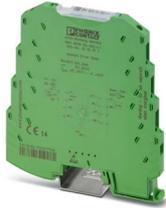
Isolatore galvanico di uscita a 3 vie per la trasmissione di segnali da 0/4 ... 20 mA dal controllore a un carico situato in campo con separazione galvanica a 3 vie tra ingresso, uscita e alimentazione, con connessione a vite
