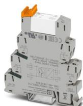
Relè ibrido a stato solido PLC-INTERFACE incl. relè di bypass con connessione a vite, per il montaggio su guida DIN NS 35/7,5, ingresso: 24 V DC, uscita: 12 V DC ... 250 V DC/ 10 A
