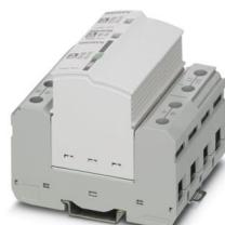
Combinazione di scaricatori di sovratensioni e di corrente atmosferica a innesto, secondo tipo 1+2 / classe I+II, per reti di alimentazione monofase con PE e N separati (L1, PE, N).
