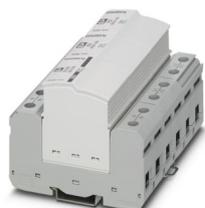
Scaricatore di corrente da fulmine a innesto senza corrente di dispersione, conforme a Tipo 1 / Classe I, per reti di alimentazione bifase, con N e PE separati (L1, L2, PE, N).
