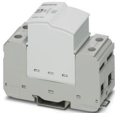
Scaricatore di corrente da fulmine a innesto senza corrente di dispersione, conforme a Tipo 1 / Classe I, per reti di alimentazione monofase con PE e N posati insieme in un conduttore (L1, PEN).
