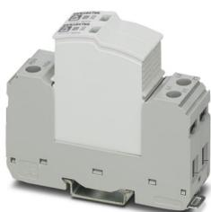
Scaricatore di sovratensioni ad innesto, secondo tipo 2/Classe II, per reti di alimentazione bifase con PE e N posati insieme in un conduttore (sistema a 3 conduttori: L1, L2, PEN), con contatto FM.
