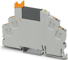
Modulo portarelè a stato solido montato con connessione push-in, composto da: base relè con espulsore e relè a stato solido in miniatura a innesto. Tensione di ingresso: 24 V DC. Uscita: 24-253 V AC/0,75 A
