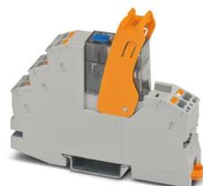
Modulo portarelè montato con connessione push-in, composto da: base relè, leva di fissaggio relè e relè a contatto di potenza con tasto di prova, LED di stato integrato e diodo di smorzamento. Esecuzione contatti: 2 contatti di scambio. Tensione di ingresso 24 V DC
