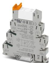
Relè ibrido a stato solido PLC-Interface incl. relè di bypass con connessione a vite, per il montaggio su guida di supporto NS 35/7,5, ingresso: 24 V DC, uscita: 24 V AC - 253 V AC/10 A
